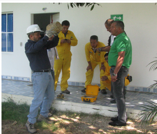
Figura 8. Experimento Caso1. Una roca de aproximadamente 5 kg de peso se deja caer desde una altura de 1.5 m a distancias sucesivamente mayores del sensor.
