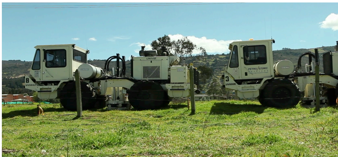
Figura 9. Experimento Caso 2. Fuente utilizando dos UNIVIBs de 26,000 lb. La prueba se realizó en cercanías de la población de Sopó, en Cundinamarca. Se registraron vibraciones a distancias variables entre 2 y 100 metros de un bebedero de concreto. Se vibró con barrido lineal de 12 segundos de duración entre 8 y 80 Hz.
